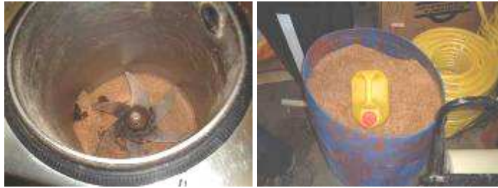
bouche d'introduction et broyeur, stockage de la sciure
