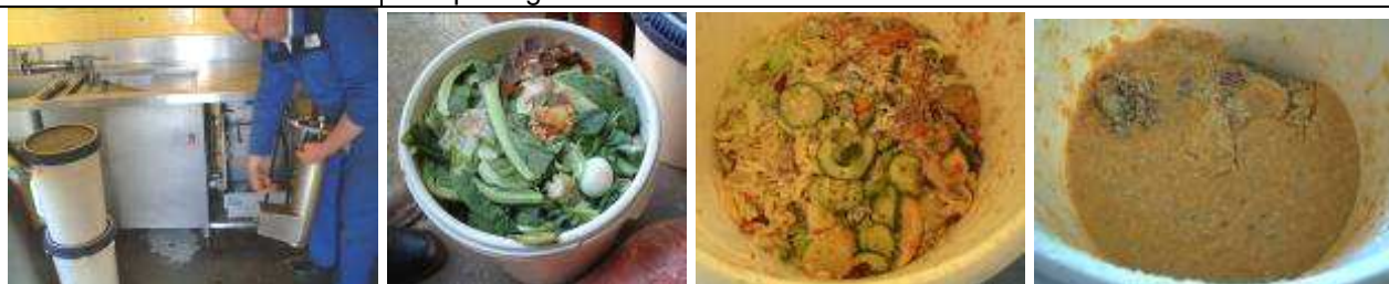
appareil de broyage-déshumidification, épluchures, restes de repas et déchets broyés
